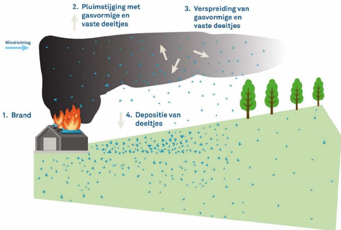
Figuur 1: Ontstaan van depositie bij brand met zonnepanelen (Bron: IFV rapport)
